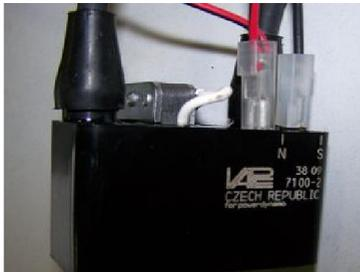
Der breitere 6,3mm Kontakt an dem rot/weißen Kabel bringt die Zündspannung (mehrere hundert Volt Wechselstrom), der schmalere 4,2mm Kontakt an dem schwarzen Kabel den Impuls. Von dem rot/weißen Kabel geht ein Abzweig. Hier wird der Kurzschlußschalter zum Abschalten der Zündung gegen Masse angeschlossen.
