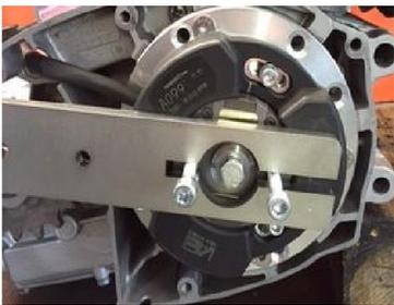
Um den Rotor sowohl bewegen, als auch beim Festziehen stabilisieren zu können nutzen Sie das beiliegende Werkzeug wie auf dem Bild gezeigt.
