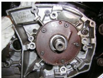
Entfernen Sie die alte Zündanlage, auch die alte Zündspule. Entfernen Sie die Paßfeder auf dem Kurbelwellenstumpf. Sie wird nicht benötigt und stört nun. Keine Angst, die Feder hatte keine Haltefunktion, sondern sollte nur zum richtigen Zündeneinstellung führen. Dies wird jetzt mit Markierungen erledigt.
