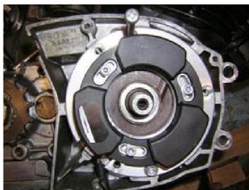
Setzen Sie die Adapterplatte so auf das Kurbelgehäuse, dass die Kabelöffnung der Platte auf etwa 7 Uhr, also in Richtung des Kabelausganges zeigt. Verschrauben Sie die Platte mit den 3 Senkkopfschrauben M5x25.
